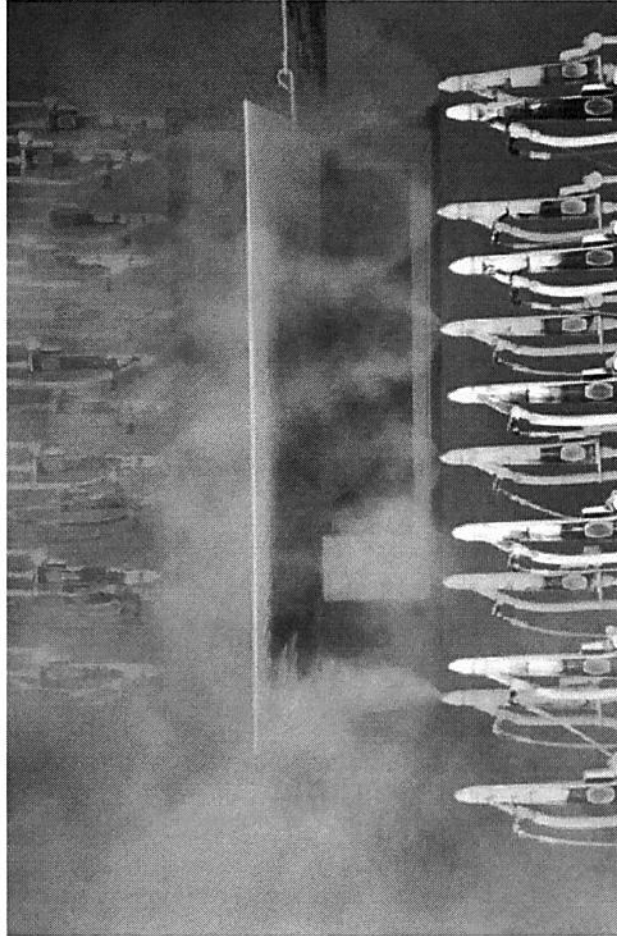
Figura 5. Imprimación de capas a láminas de acero. Fuente: Material suministrado por la empresa Florida Aquastore.
