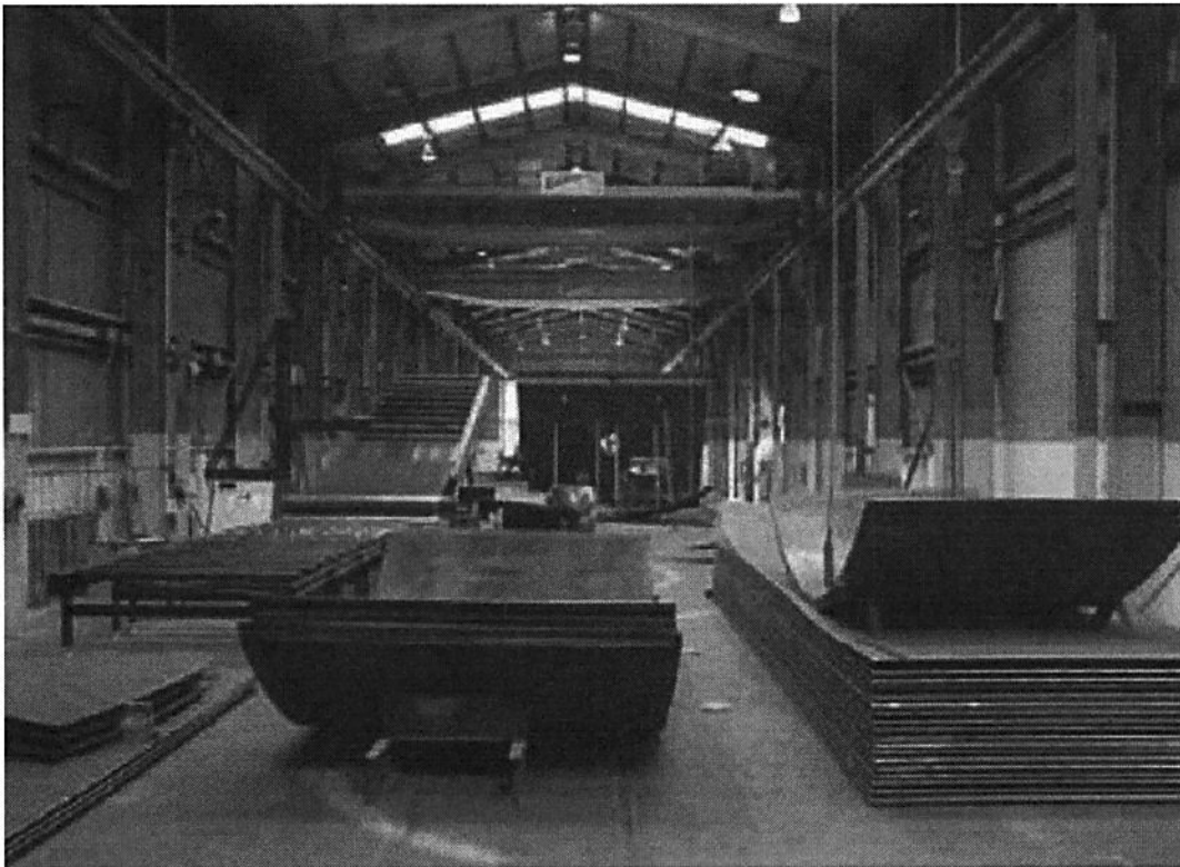
Figura 2. Láminas de acero luego del proceso de doblado. Fuente: Material suministrado por la empresa Florida Aquastore.
